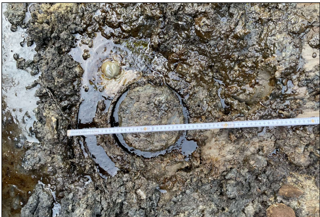
Abbildung 4: Aufgrabung der Bohrung Holstein 10 am 17.09.2025 mit insgesamt vier erkennbaren Rohrtouren
