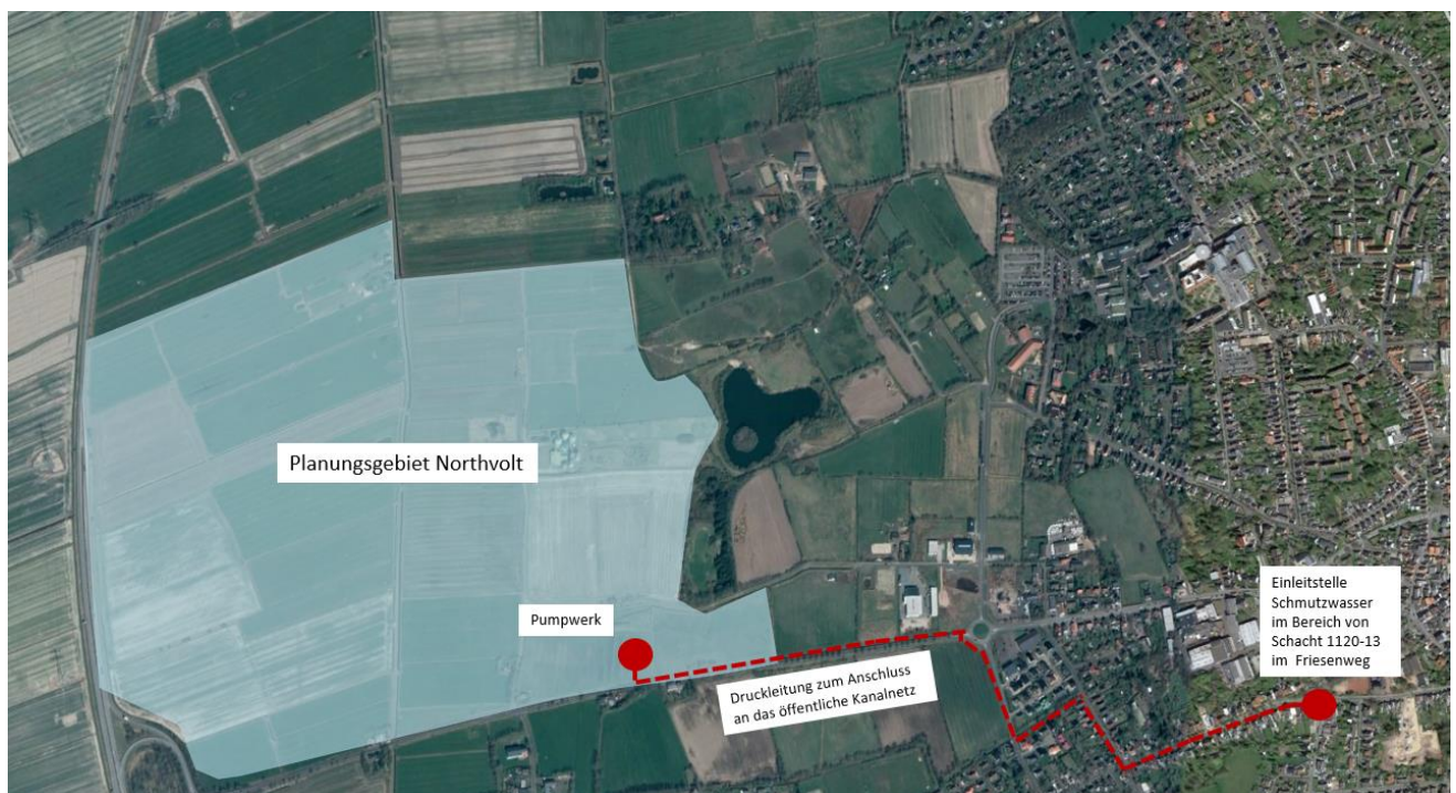
Abbildung 18 Öffentliche Anschlussmöglichkeit Schmutzwasser (Quelle: GoogleEarth)
